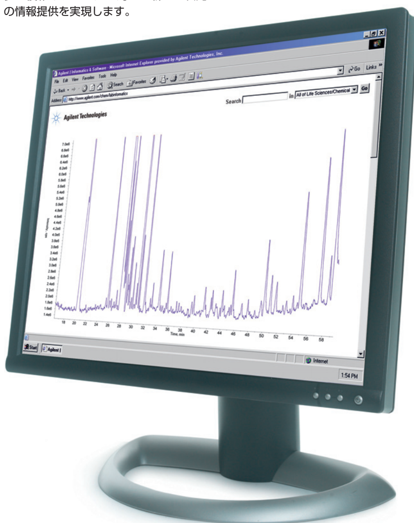
Agilent 1200 シリーズ Rapid Resolution システムと TOF による 薬用人参抽出物の高分離能クロマトグラフィー。 平均のピーク幅は 0.13 min、ピークキャパシティは 540 です。
