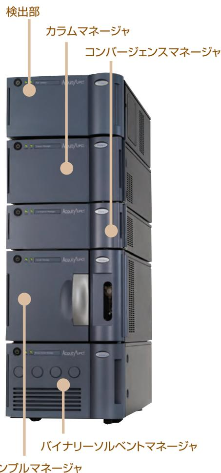
※ UPC<sup>2</sup> は高圧ガス保安法が適用されます。
